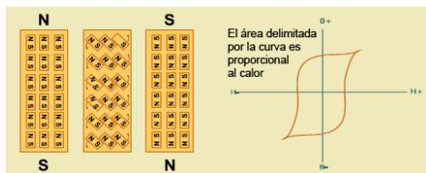
Cuando la corriente eléctrica cambia de sentido (CA), el campo magnético creado se contrae y se crea en el sentido opuesto con el cambio del sentido de la corriente. Si se coloca un segundo cable dentro de ese campo magnético alterno, se genera una corriente alterna en el segundo cable. La corriente del segundo cable es proporcional a la corriente del primer cable y su magnitud es el inverso del cuadrado de la distancia que los separa.
